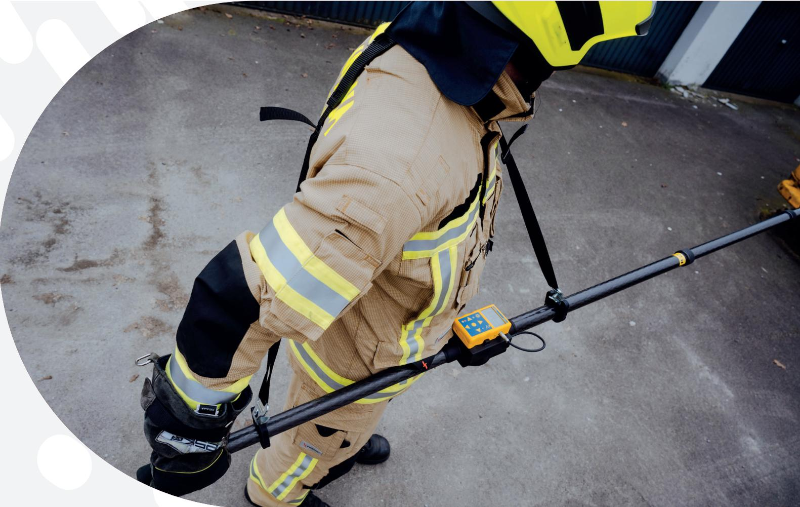
Das neue DolMo-Telescope ergänzt unsere DolMo-Produktreihe, sowie das vielseitige NUVIATech-Sondenprogramm. Es ermöglicht präzise Messungen aus der Ferne oder aus der Deckung heraus. Es ist kompatibel mit unseren Geiger-Müller-Detektoren, hochempfindlichen NaI-Detektoren, sowie  $\alpha+\beta/\gamma$ -Kontaminationssonden.
